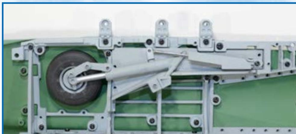
**4** Разместите правую основную опору шасси между элементами силового набора центральной части фюзеляжа, как показано на снимке.
