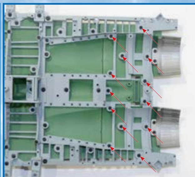
**3** Установите панель верхней части хвостовой секции фюзеляжа из № 9 на силовой набор хвостовой части корпуса (D046), как показано на снимке. И соедините детали винтами ВМ.
