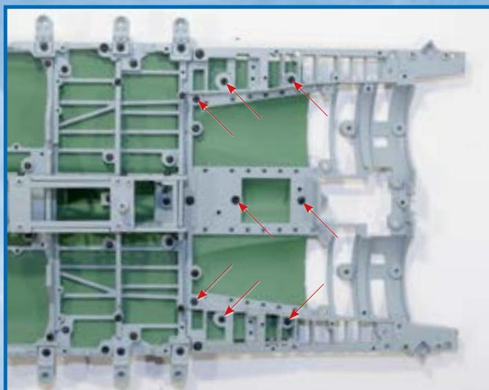
**2** Затем установите панель верхней части хвостовой секции фюзеляжа (D013) на силовой набор хвостовой части корпуса (D046), как показано на снимке. И соедините детали винтами ВМ.
